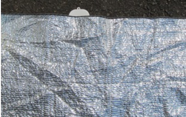
ポリエチレン糸にアルミ蒸着、鏡のように光る遮熱ネット (遮光率約 95%)
